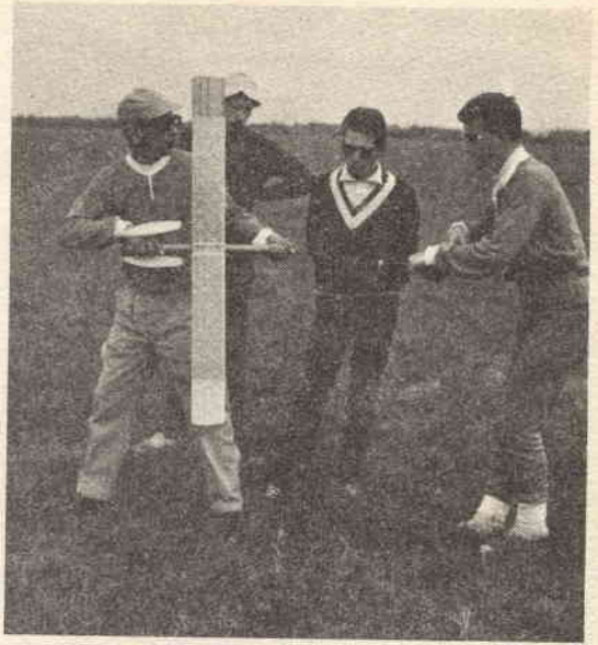
Un esempio di modello con trave di coda staccabile dal tubo portamatassa, nel quale il caricamento viene fatto dalla parte posteriore.
