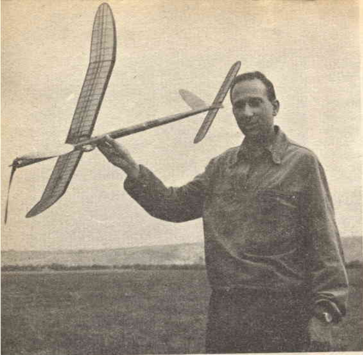
Un bellissimo Wakefield la cui fusoliera è realizzata con il sistema illustrato in fig. 11. Si noti sotto la pinnetta con l'autoscatto per l'installazione dell'antitermica.
